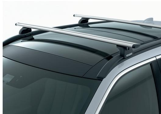
**Дуги багажника поперечные**
